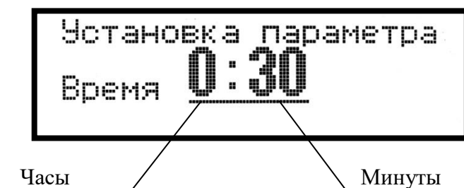
Рисунок 6 – Вид дисплея в состоянии задания времени нагрева
